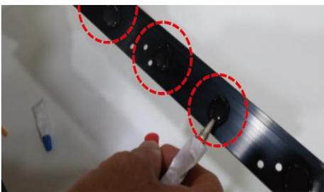
図.4 同梱されている強力接着剤Aをレールに図のように塗った後、同じ場所に別の色の接着剤Bを同様の量で塗ります。
