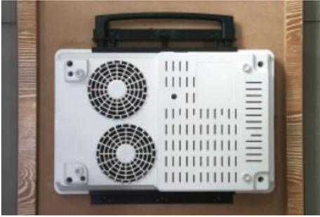
図.1 製品を取り付けるテーブルの下に、製品のサイズに合わせてレール位置を決めます。
