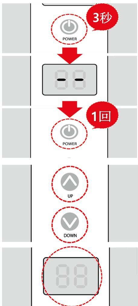
**図.2** POWERボタンを長押しして「 - - 」であることを確認した後、POWERボタンをもう1回押します。
